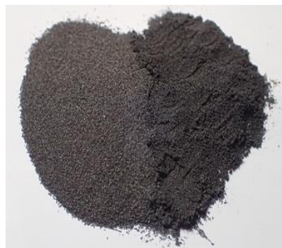
図 4.ガラス容器の壁の鉄粉 [ 灰色 : ( \text{Fe} ), 黒色 : ( \text{Fe}_3\text{O}_4 ), 褐色( \text{Fe}_2\text{O}_3 )]
